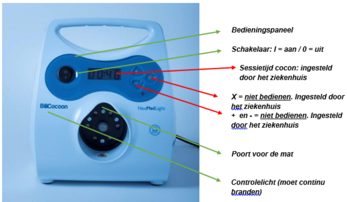
Figuur 2: de lichtbak (met de poort voor de mat & het bedieningspaneel)
